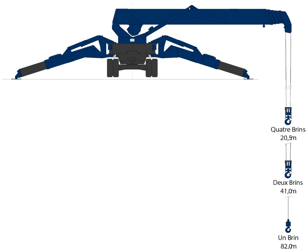
Charge nominale totale avec stabilisateurs en position maximum avec crochet chercheur 850kg
